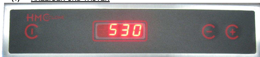
AN/AUS Taste Anzeige rpm und Leistung in % Drehzahl/Leistung reduzieren/erhöhen
